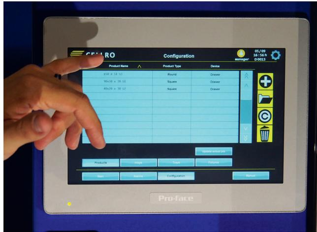
4 Über ein Touch-Display lassen sich werkstück- und bearbeitungs-spezifische Parameter komfortabel und schnell einstellen
