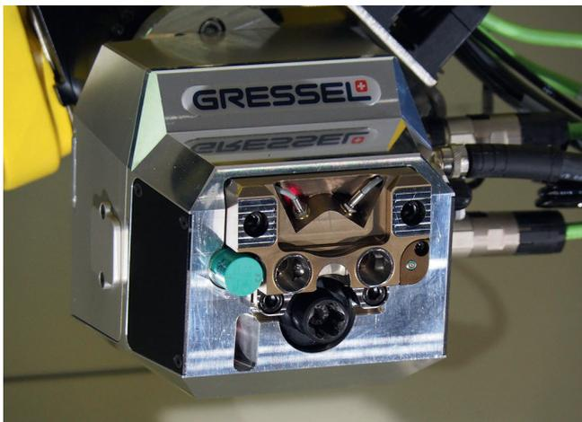
3 Die Kupplung zum Handgelenk des Roboters verfügt mittig über eine Servo-Spannachse, die den mechanischen Nullpunkt-Schraubstock öffnet oder schließt. Die integrierte Sensorik überwacht den Spannungsvorgang (© Hanser)
